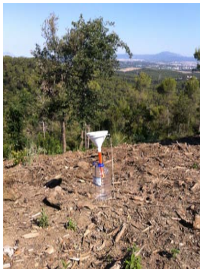
Imagen 20: Pluviómetro colocado en suelo desnudo.
